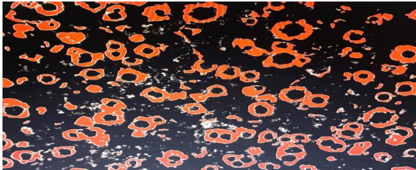
Şekil 2. GGG – 60 Küresel Grafitli Dökme Demir İçyapı (SEM) Görüntüsü
